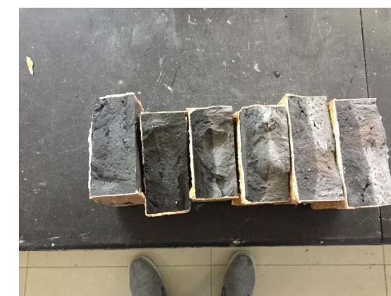
图 3 耐老化后憎水剂的渗透深度
