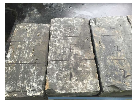
图 2 耐老化试验用古城墙砖
